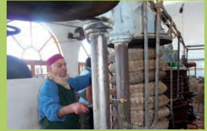
Die mit Olivenbrei gefüllten Alfagras-Matten werden gepresst...
