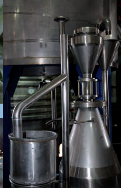
Hochmoderne Destillieranlage in der Firma Bigaflor SA: dort werden die Blüten innerhalb von 24 Stunden mit modernster Technologie über Wasserdampfdestillation in verschiedenen Produktionsprozessen zu Orangenblütenwasser und Neroliöl destilliert.
